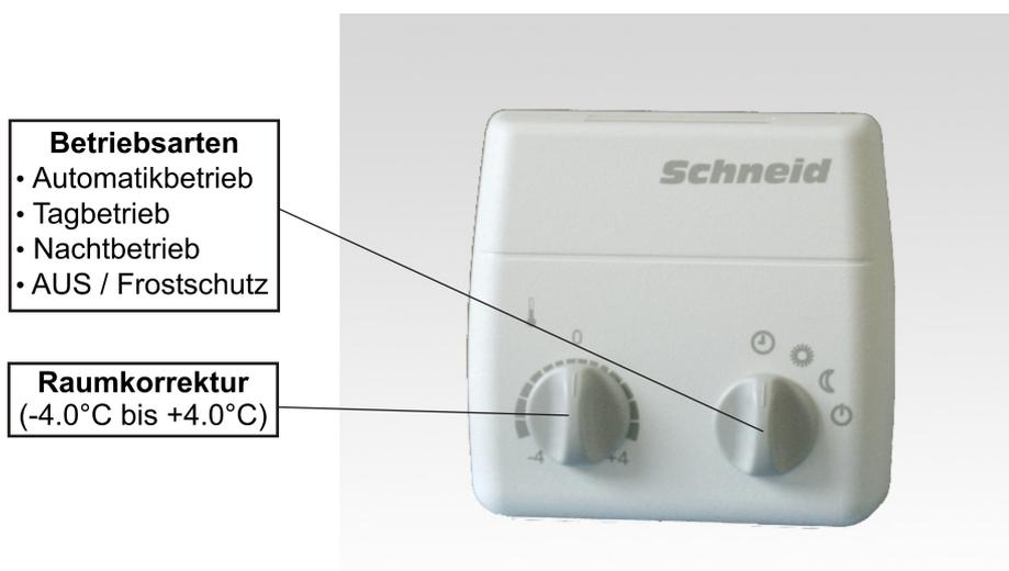
Für die Vorwahl der Betriebsart ist ein **AUTOMATIK / TAG / NACHT / AUS** Vorwahlschalter vorgesehen. Zur Veränderung der Raumsolltemperatur ist ein Einstellpoti mit einem Bereich von plus/minus vier Grad vorhanden. In der Fernbedienung ist ein Raumfühler eingebaut, der zur Anwendung verschiedener Heizungsregelprogramme und zur Optimierung des SCHNEID Regelgerätes herangezogen werden kann.
