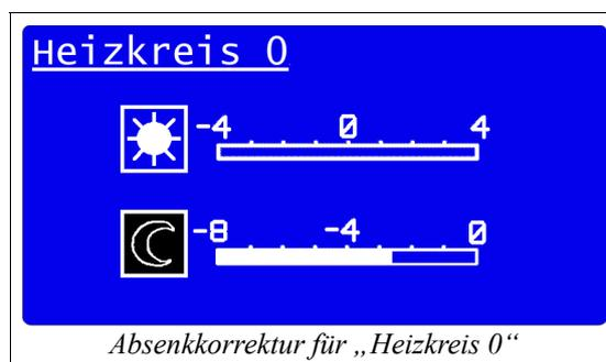
Die Korrektur für jeden Heizkreis kann individuell verstellt werden. Die Bezeichnung des jeweiligen Heizkreises wird in der ersten Zeile angezeigt.
